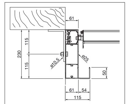
TR4520 Schnitt Trägerprofil
