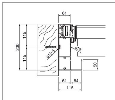
TR4120 Schnitt Trägerprofil
